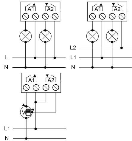
Figure 2 : Exemples de connexions (de gauche à droite et de haut en bas) : 2 charges, 2 charges à phases différentes et volet
