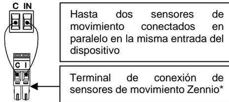
Hasta dos sensores de movimiento conectados en paralelo en la misma entrada del dispositivo
