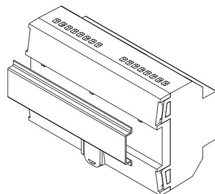
Figura 3: Montaje de MAXinBOX 16 v4 en carril DIN
