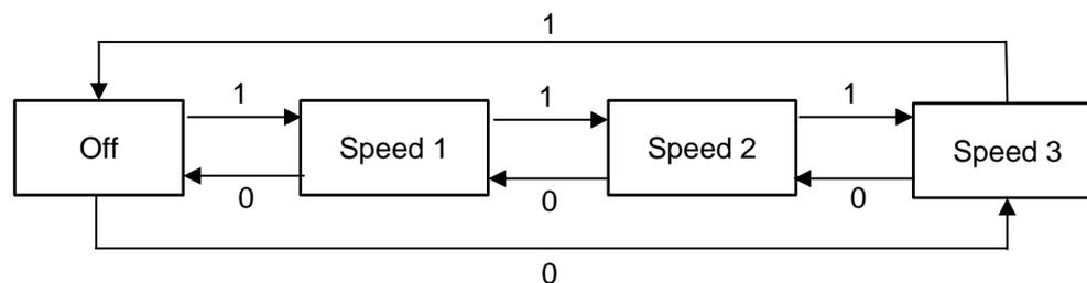
Figure 8. Cyclical fan step control
