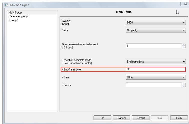
**Figure 12. End Frame Byte FFh**
