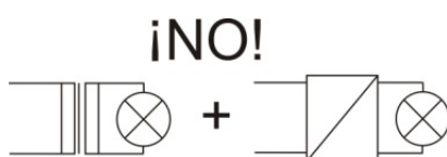
Carga inductiva + carga capacitiva
