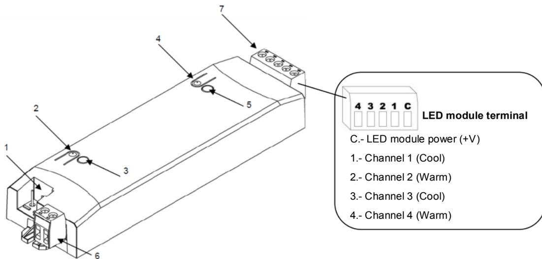
1.- KNX Connector 2.- Programming Button 3.- Programming Indicator 4.- Test Button
